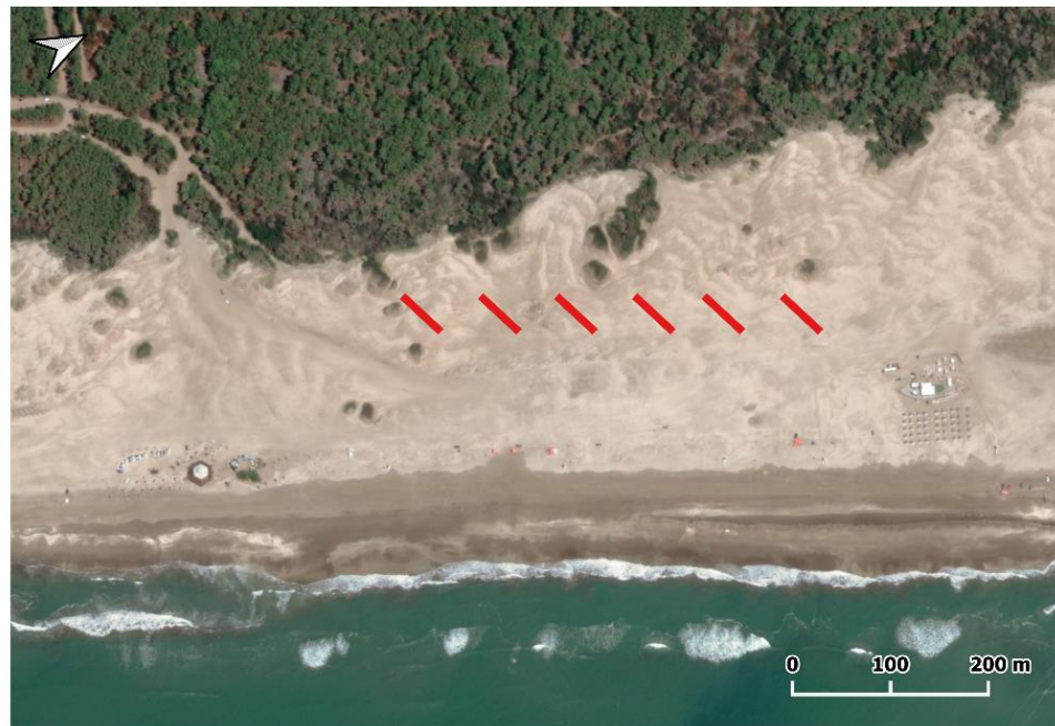
Figura 74. Ubicación y orientación recomendada de una serie de enchinados de aproximadamente 30 m de largo en un sector de playas al norte de Pinamar. Los vallados se dispusieron en dirección normal al viento sudeste; en línea recta entre con una separación al menos igual al largo de cada estructura; y ubicados directamente por delante del pie de duna y el comienzo de la vegetación dunar.
