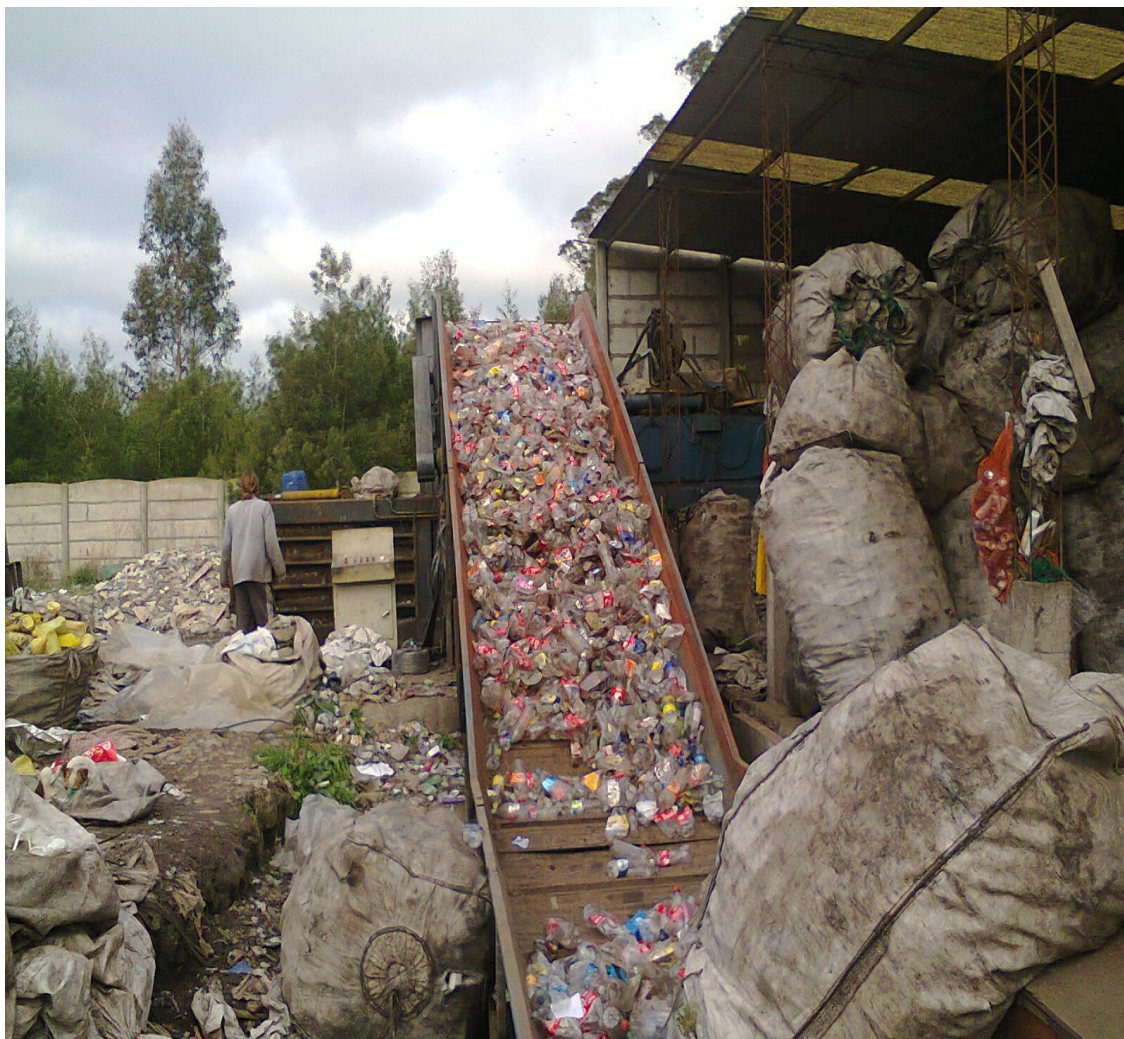
Foto 31: Tinglado para el acopio de bolsones con botellas de PET y cinta transportadora hacia la tolva de alimentación de la enfardadora, Acopiadora Fénix
